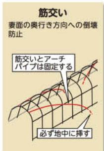
図1 ハウスの補強
