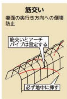
図1 ハウスの補強
